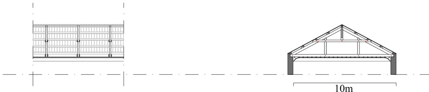
Coupes longitudinale et transversale dans la charpente de la chapelle de l'Hospice des aveugles (relevé et dessin R. Wibaut).
