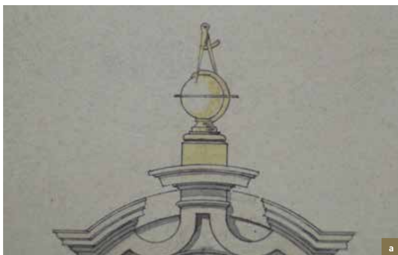
Le Sac. Mappemonde. a) dessin d'archives ayant servi à la fabrication de la nouvelle mappemonde en zinc, suite à la dégradation trop importante de l'existante (© AVB); b) nouvelle mappemonde dorée au sommet du pignon (© CPH, 2014-2015).
