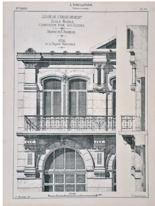
Fig. 3 L'École Modèle. Plan, coupe et détail de la façade principale (L'Émulation, 1879, pl. 40, 42, 43).
