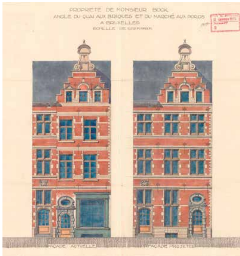
Fig. 3 Transformation de la façade de l’extension (AVB/TP 32504, 1917-1919).
