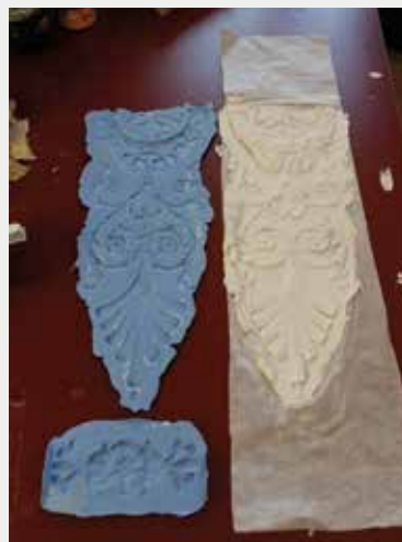
Fig. 11 Emprunte des moules de la cage d'escalier principale (©Ma 2 , août 2018).
