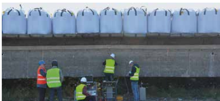
Fig. 9a Les ingénieurs analysent la structure du pont et indiquent les fissures à la craie blanche (J.-M. Basyn, 2018 © Urban.brussels).
