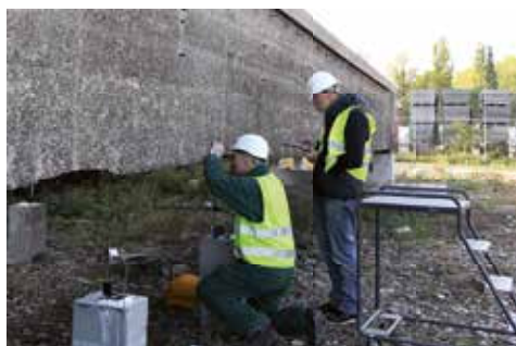
Fig. 9a Les ingénieurs analysent la structure du pont et indiquent les fissures à la craie blanche (J.-M. Basyn, 2018 © Urban.brussels).
