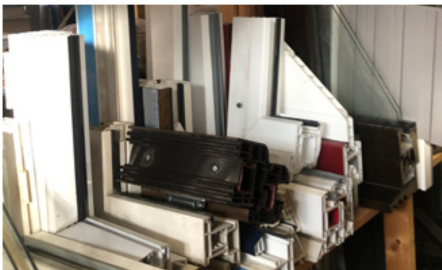
FIG. 3 Parmi les éléments de construction qui ont connu une forte évolution au cours des dernières décennies du XX e siècle, notamment en raison de normes d'isolation plus strictes et grâce à des techniques de production innovantes, figurent les châssis de fenêtre, comme le montrent ces échantillons de la matériauthèque de l'UCLouvain (BAIU-Bruxelles) (© Marylise Parein, 2023).
