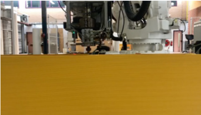
FIG. 16 Un panneau imprimé en 3D a été testé pour la maquette. Il se compose essentiellement de matières premières d'origine végétale qui, après démontage du panneau, peuvent être réutilisées jusqu'à sept fois. La maquette a permis de constater, d'une part, que l'impression 3D est une technologie prometteuse et, d'autre part, que ce panneau en particulier n'était pas adapté aux applications extérieures (© Aectual).
