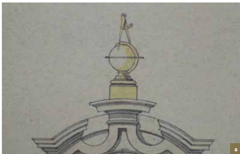
Den Sack . Wereldbol. a) archieftekening die als model diende voor het vervaardigen van de nieuwe wereldbol in zink, omdat de bestaande niet meer te redden was (© SAB); b) nieuwe vergulde wereldbol op de geveltop (© CHE, 2014-2015).
