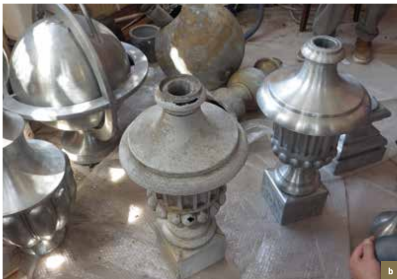
Den Sack . Zinken vaas. a) oorspronkelijk element vol barsten en gaten; b) oude en nieuwe elementen (© CHE, 2014-2015).
