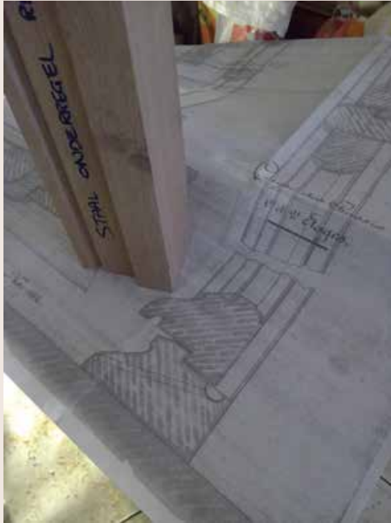
Den Pauw. Op basis van de archieftekeningen op ware grootte konden de profielen heel precies worden hersteld (© CHE, 2015).
