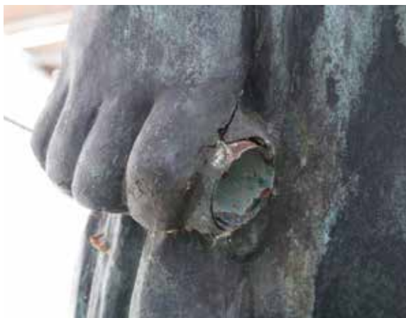
Afb. 11a Oude herstelling ter hoogte van de hand, na verwijderen drietand (© Metafose).
