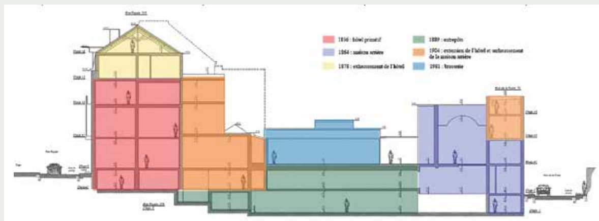
Doorsnede van het gebouw met chronologie van de verbouwingen (© ARCHistory / APEB, 2014).
