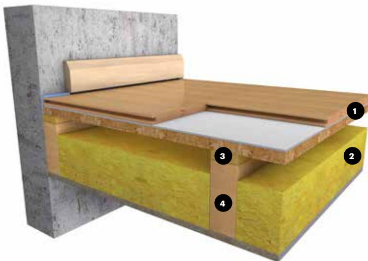
AFB. 5 Samengestelde isolatie langs bonven aangebracht tussen de dragende elementen. 1: vloerpanelen; 2: absorberend materiaal; 3: dempenden strook; 4: te verstevigen balk indien nodig (Infographie Oma Kiwi Design).
