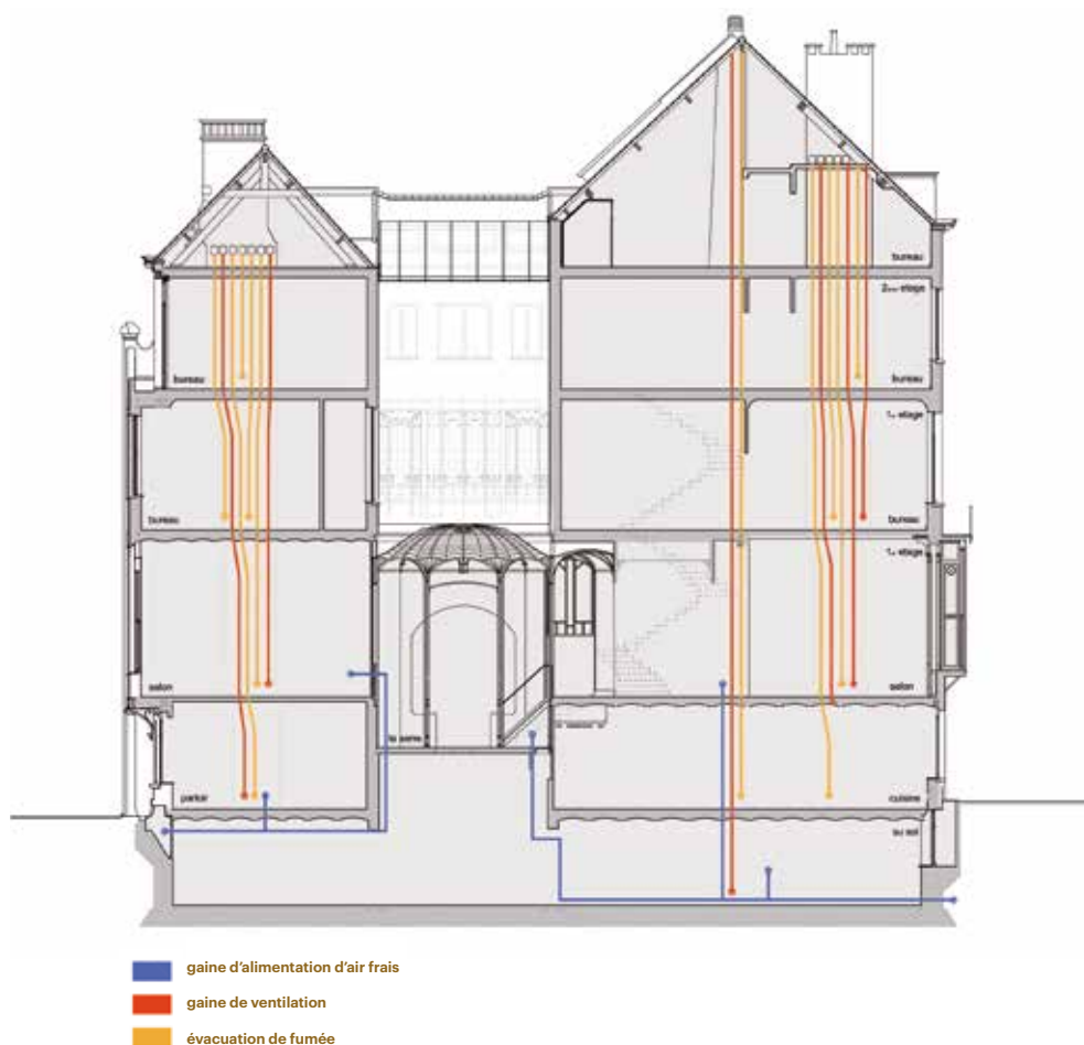
AFB. 13 Schema van de oorspronkelijke luchtcirculatie in Hôtel van Eetvelde op het syntheseplan ventilatie, 2016 (© B. Van der Wee Architects).
