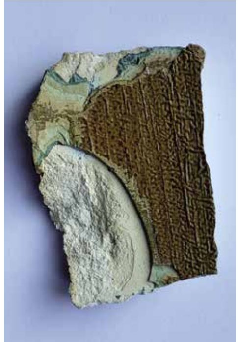
AFB. 14 Restant van een ouder plafond van de tweede zaal met een eerste groene afwerklaag. (© E. Job)
