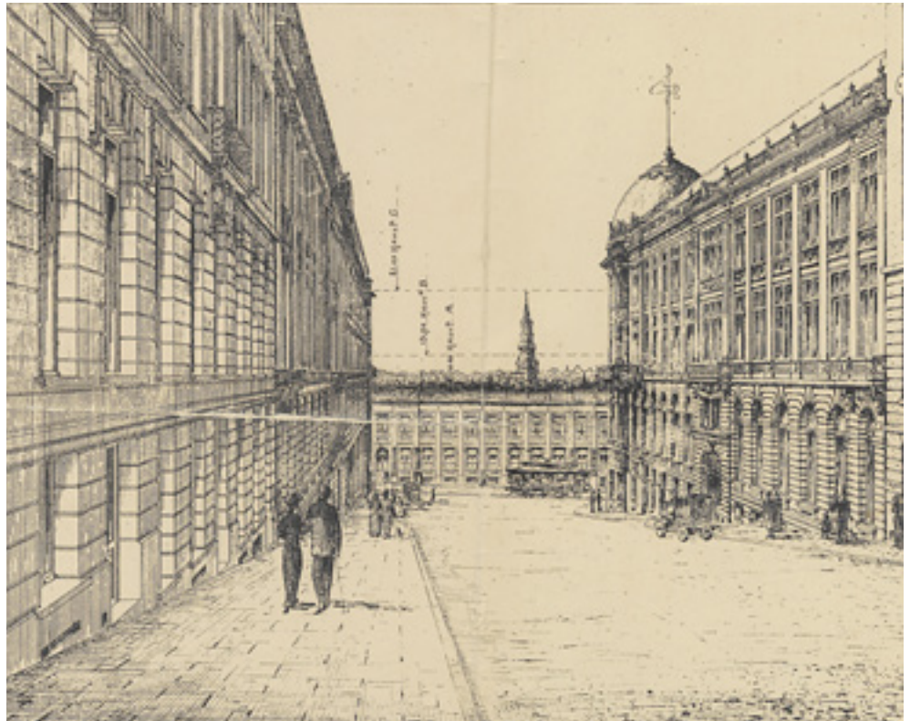
AFB. 8 Projectie vanaf de passage de la Bibliothèque . In het perspectief is een gebouw getekend dat de opgelegde bouwhoogte respecteert. Gedrukte tekening (© SAB, Papieren Charles Buls, 19b).
